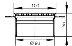
Pieza portadora de acero inoxidable con soporte y anillo de fijación de altura
