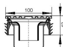
Pieza portadora de acero inoxidable para recubrimientos, con soporte y sifón integrado
