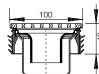
Marco de contorno con rejilla de diseño de acero inoxidable PURE, con soporte y sifón integrado
