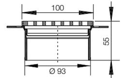
Marco de contorno con rejilla de diseño de acero inoxidable CURVE, con soporte y anillo de fijación de altura Marco de contorno de 100 x 100 mm, posibilidad de desplazamiento en todas las direcciones para grosores de 3 a 30 mm
