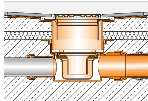
Fig.: marco con rejilla clásica y sumidero con sifón integrado
