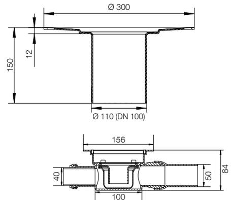
Conjunto de desagüe DN 50/70 con sifón, salida DN 50 (50mm), salida DN 50/70 (50 / 75 mm) con conexión rígida
