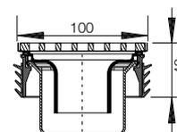
Marco de contorno con rejilla de diseño de acero inoxidable CURVE, con soporte y sifón integrado
