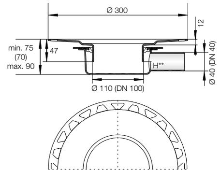
Conjunto de desagüe DN 50 con sifón, salida opcional DN 40 (40mm), salida DN 50 (50mm) con conexión articulada
