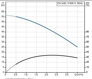
Líquido bombeado = Agua Temperatura del líquido durante el funcionamiento = 20 °C Densidad = 998.2 kg/m³
