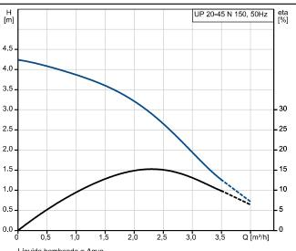
Líquido bombeado = Agua Temperatura del líquido durante el funcionamiento = 60 °C Densidad = 983.2 kg/m³
