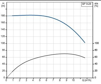
Líquido bombeado = Agua Temperatura del líquido durante el funcionamiento = 20 °C Densidad = 998.2 kg/m³
