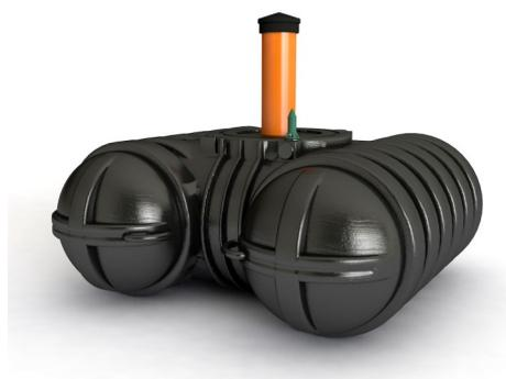
Los depósitos de acumulación DEC T disponen en su parte superior de una torre de realce circular Ø 200mm para realizar el mantenimiento y vaciado. También, en su parte superior, disponen de dos entradas Ø110mm (ideal para instalar tuberías de llenado y en caso de ser obligatorio, uso de un rebosadero DN110). En la parte inferior del cuerpo central disponen de zonas planas específicas para poder taladrar e instalar elementos que permitan el vaciado y/o conexión de los depósitos.
