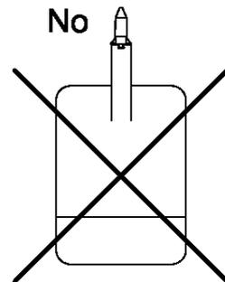
No instalar el transmisor encima de un tubo, las medidas se falsean.
