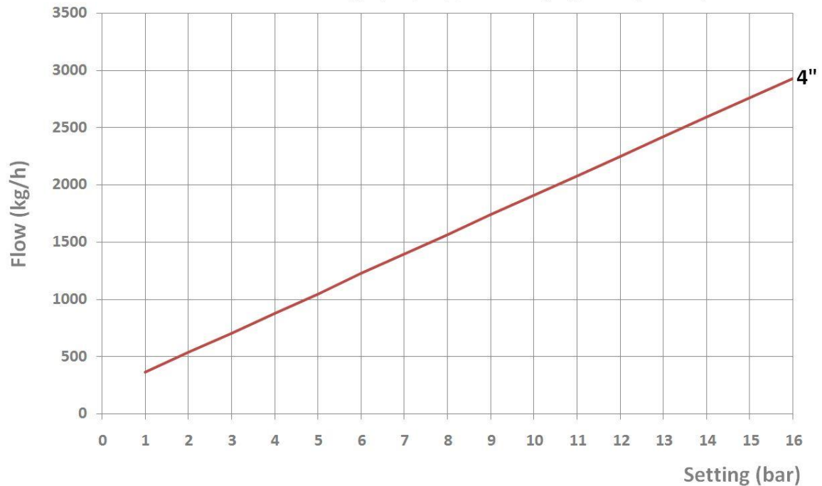
Caudal de descarga (Vapor) / Discharging flow (Steam)
