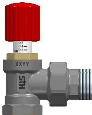
La válvula de presión diferencial se instala para evitar la sobre presión en las instalaciones de calefacción, debido al cierre simultáneo de válvulas termostáticas o válvulas de zona. La válvula de by-pass ahorra energía, al proporcionar un caudal mínimo constante. También elimina cualquier problema de ruido debido a una sobrecarga de la bomba y ofrece protección, prolongando la vida útil de los equipos en el sistema.
