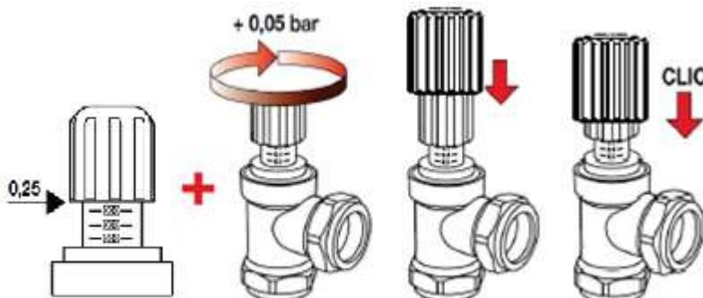
Después de realizar el ajuste, bajar la cobertura de plástico, para fijar el volante. El ajuste queda bloqueado, pero se puede leer fácilmente la regulación.
