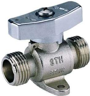
Las válvulas de esfera automáticas con muelle Boston Gas están destinadas a instalaciones domésticas e industriales como elemento de apertura o corte del fluido. El accionamiento es mediante 1/4 de vuelta (presionar y girar). Son fácilmente precintables y bloqueables. Están diseñadas y garantizadas para el uso en instalaciones con gases de 1<sup>a</sup>, 2<sup>a</sup> y 3<sup>a</sup> familia, especificados en la norma UNE EN 437.
