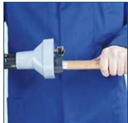
Los extremos de los tubos y las soldaduras exteriores de los accesorios deben limpiarse cuidadosamente y de forma mecánica.
